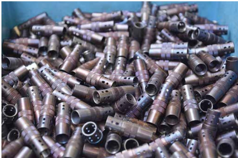
**1** Vakuumgehärtetes Präzisionsdrehteil, gefertigt von Lohndreher Berggötz: Mit 100-Prozent-geprüfter Qualität und sehr kurzer Lieferzeit punktet der Alles-aus-einer-Hand-Dienstleister in einem hart umkämpften Marktsegment (© Hanser)
